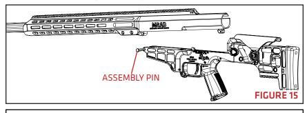
NOTE: NO FURTHER DISASSEMBLY OF THE RECEIVERS IS RECOMMENDED OR NECESSARY FOR OPERATOR LEVEL MAINTENANCE.
